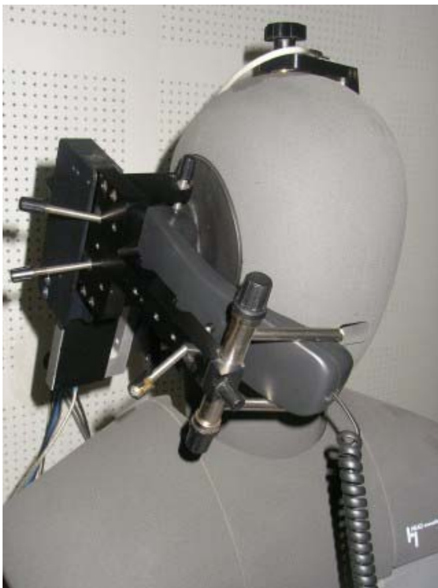
人工头安装话柄时话柄安装在一个压力传感器上
